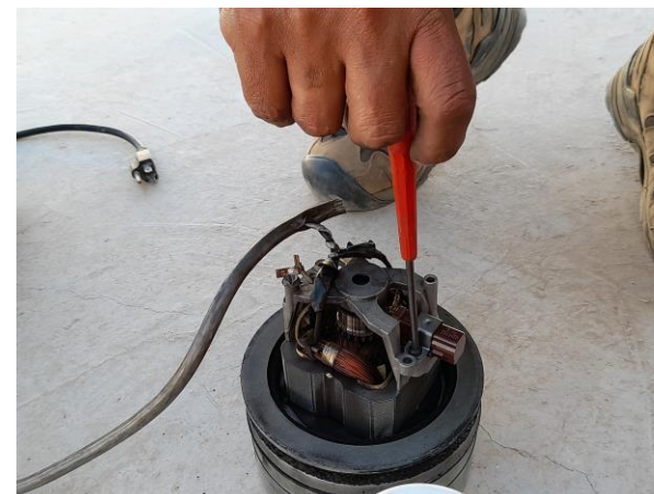
Cambiar los carbones
