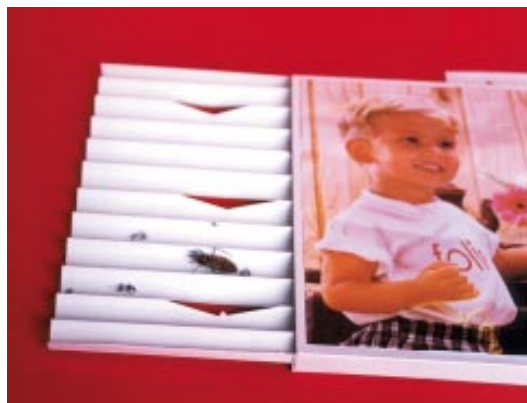
Fig. 42 Biosensor para la detección pasiva de triatominos.
