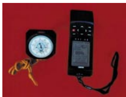
Fig. 34 Receptor del sistema de posicionamiento global (GPS) y altímetro.
