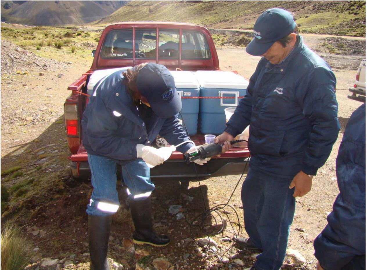
E-02: Limpieza de electrodos con agua destilada a cargo de personal de DIGESA y SEDAPAL.
