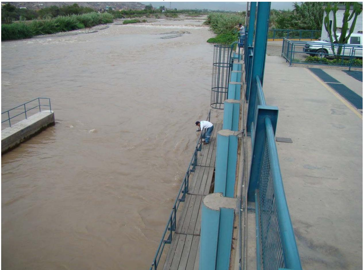
E-24: Río Rímac, Bocatoma 1 - La Atarjea, medición de parámetros de campo.
