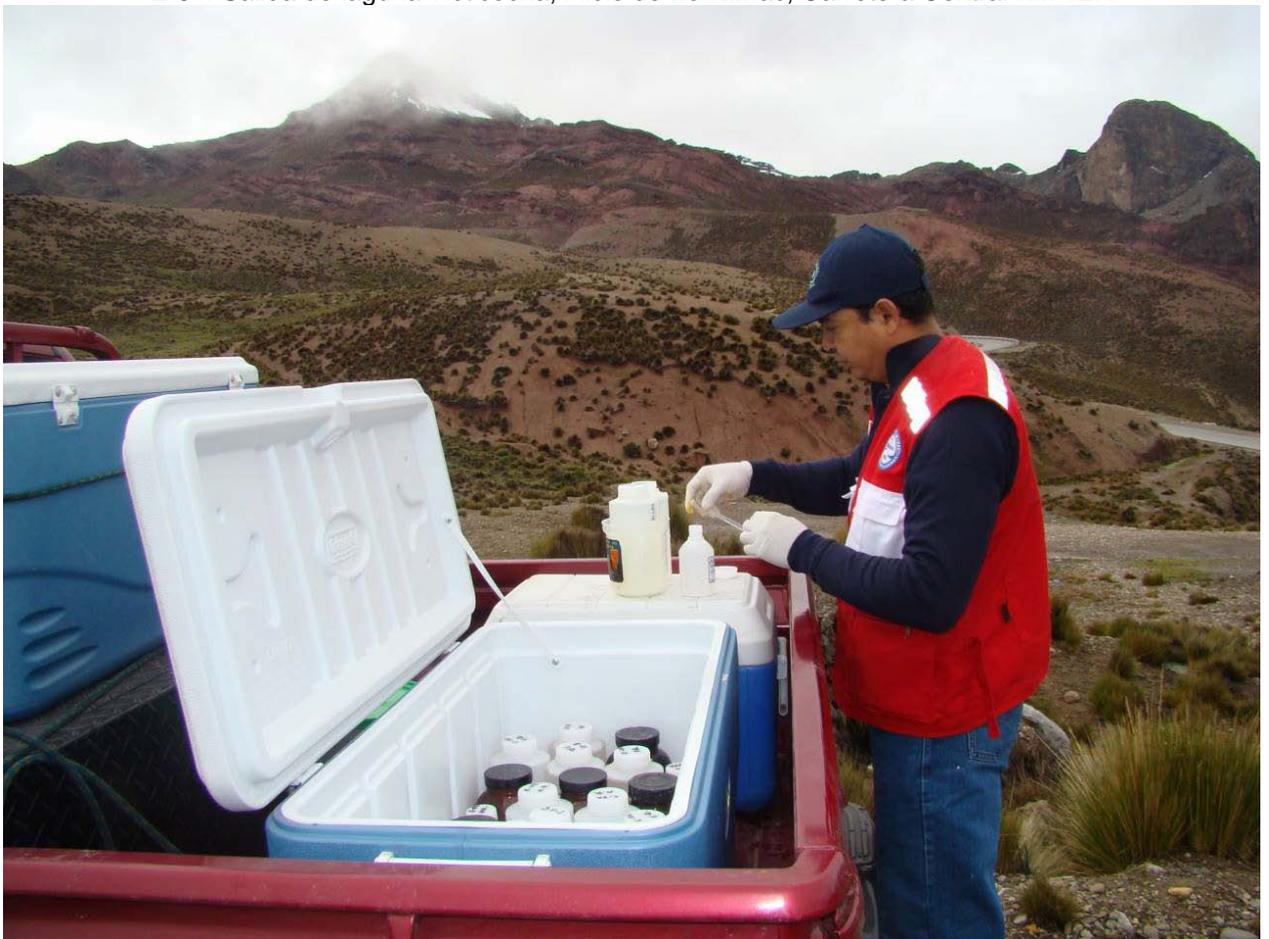
E-01: Preservando las muestras para el análisis de metales pesados con ácido nítrico 1 + 1.
