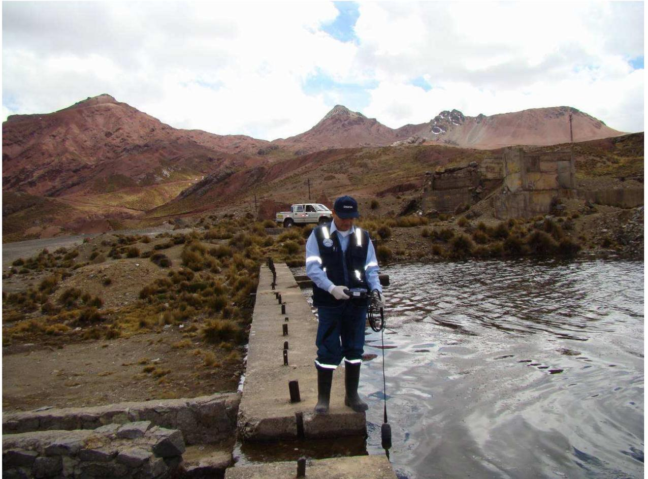
E-01: Medición de parámetros de campo: pH, temperatura, conduct.esp., turbidez y oxígeno disuelto.
