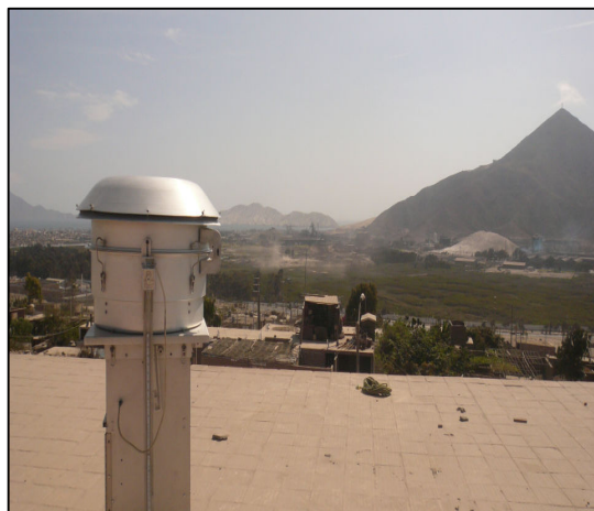
Instalación del equipo muestreador de partículas menores a 10 Micras (PM10) y de la Estación Meteorológica en la Institución Educativa Inca Garcilazo de la Vega.
