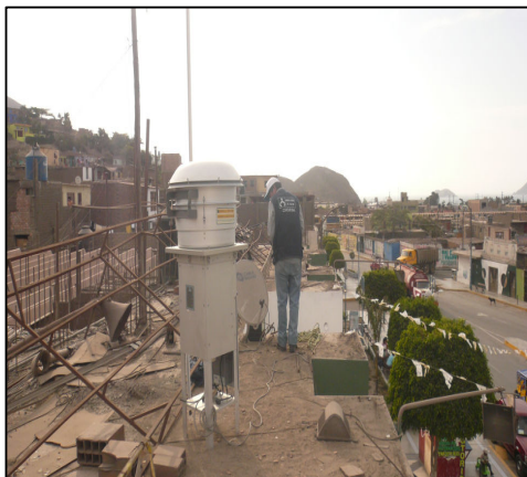
Instalación del equipo muestreador de alto volumen Hi Vol en la Municipalidad de Coishco.
