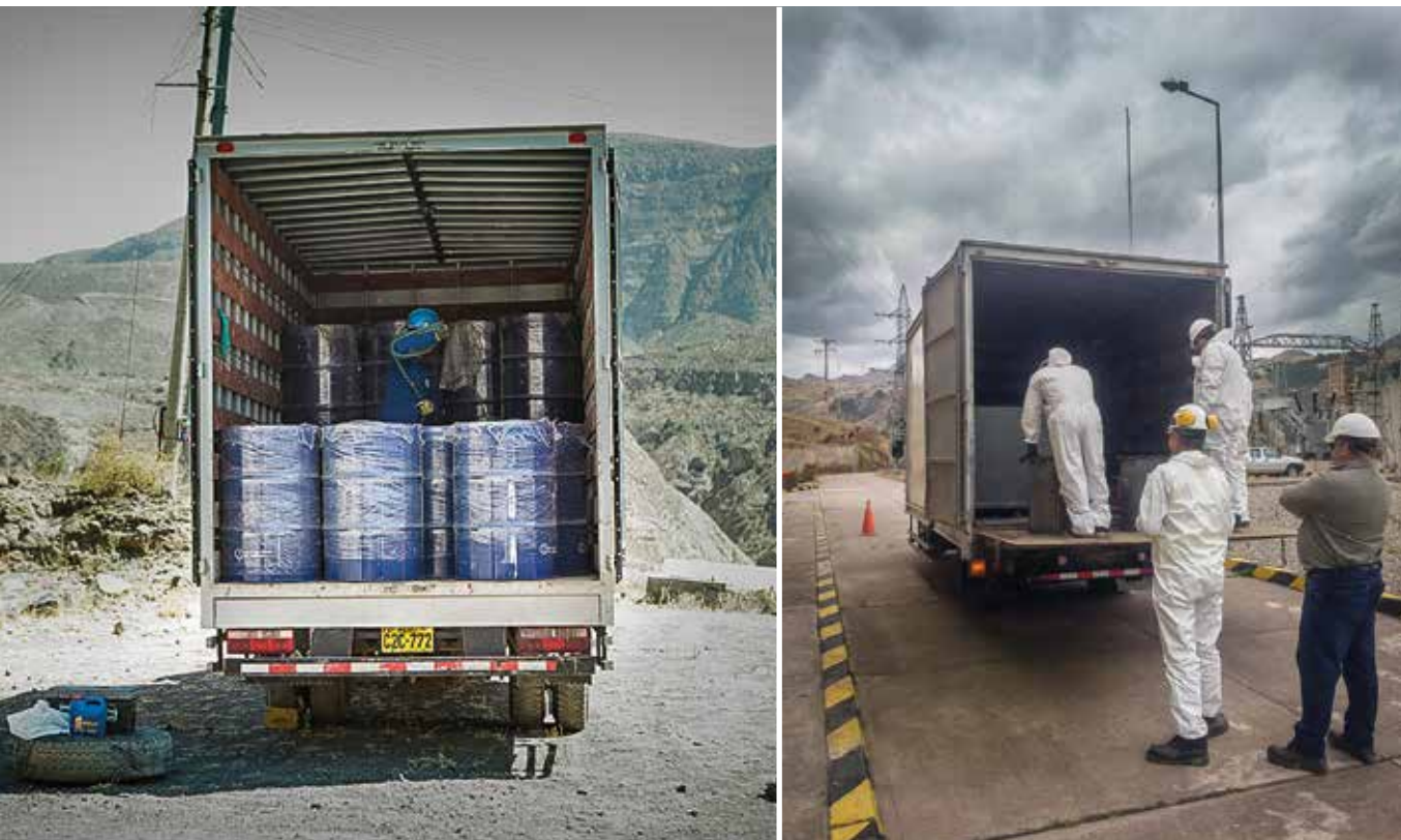
Foto N°13: Transporte de equipos y cilindros con aceite con PCB
